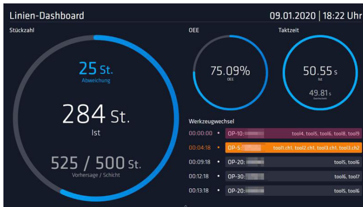
Abbildung 2: Linien Dashboard der Smart Production Apps zeigt Stückzahlprognose zum Schichtende, Live-OEE und Taktzeit sowie anstehende Werkzeugwechsel.
